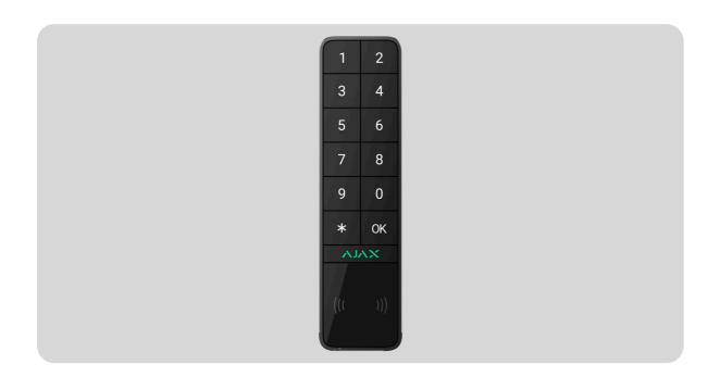
**KeyPad Outdoor Jeweller** ist eine drahtlose Tastatur, die für die Verwaltung von Ajax-Systemen entwickelt wurde. Benutzer können sich mit Smartphones authentifizieren, **Etikett** Schlüsselanhänger, **Bestehen** Karten und Codes. Das Gerät ist sowohl für den Außen- als auch für den Innenbereich bestimmt.
